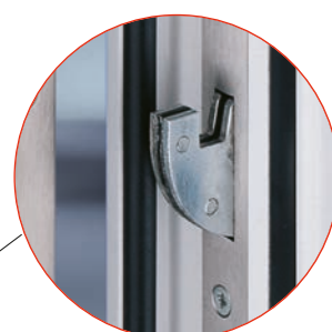
Schwenkriegel Greifen von unten in die massive, sechsfach verschraubte Schließplatte und lassen sich daher weder seitwärts herausdrücken noch aufhebeln.
